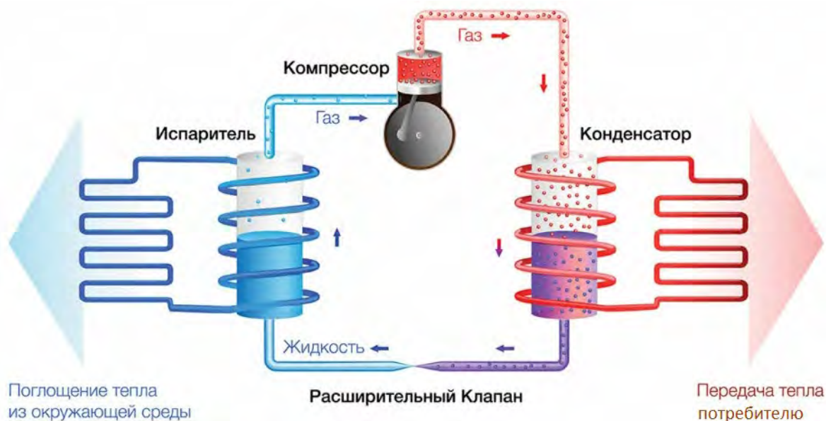
Рисунок 1. Принцип действия парокомпрессионного теплового насоса
