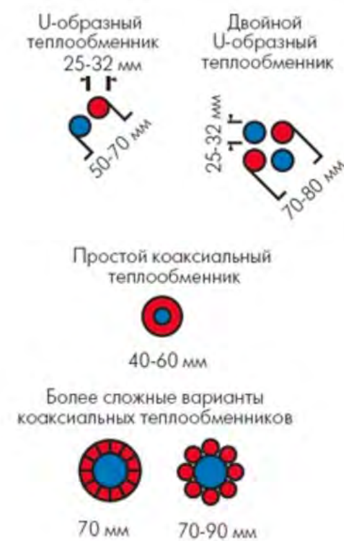
Рисунок 5. Конструкции грунтовых теплообменников
