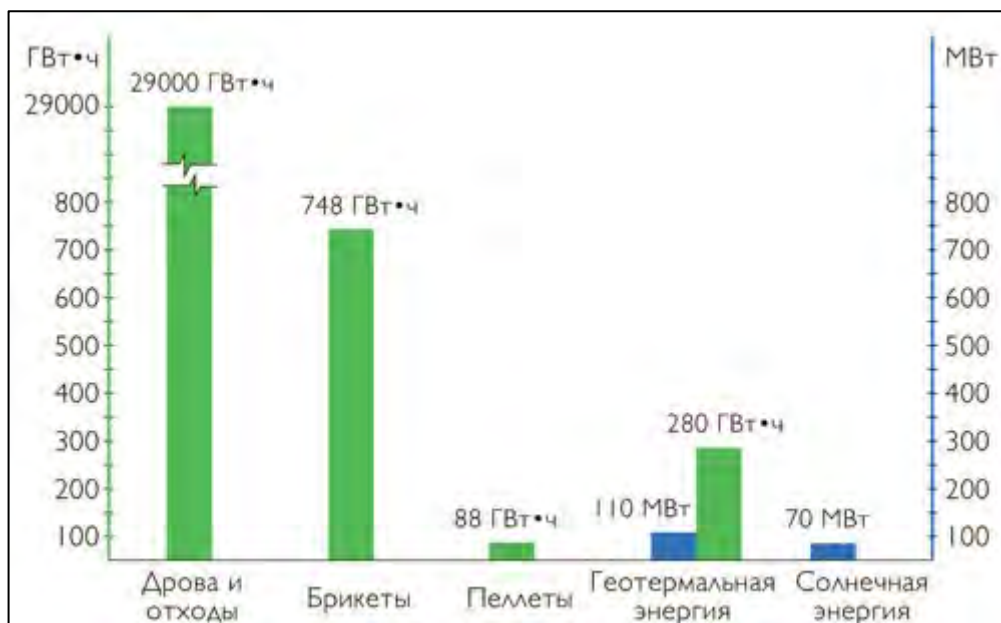
Рисунок 6. Установленные мощности и выработка тепловой энергии на основе ВИЭ в России в 2020 году
